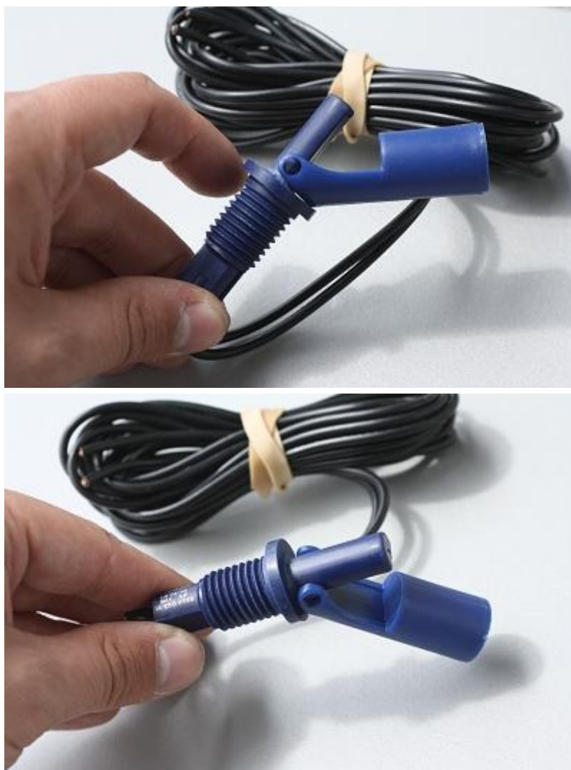
Ukázka upevnění nylonového plováku snímače Honeywell LRNH31S42
